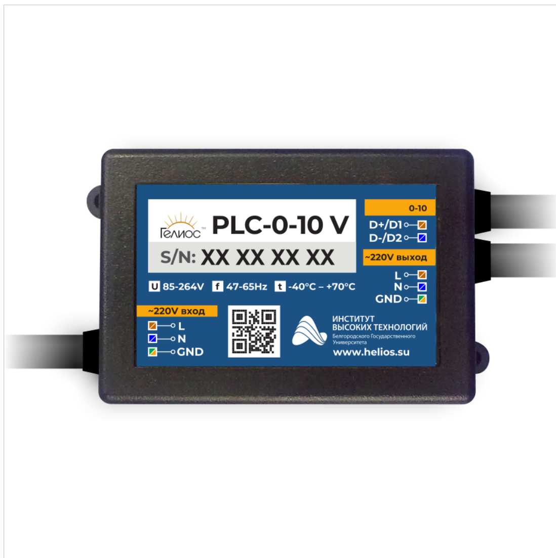
Рисунок 1. Устройство дистанционного управления светильниками PLC-0-10 V
