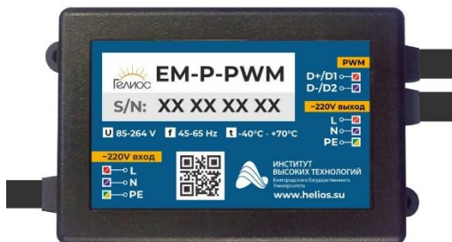
Рис. 1. Устройство управления светильниками, марка «Гелиос» PLC-PWM (EM-P-PWM)
